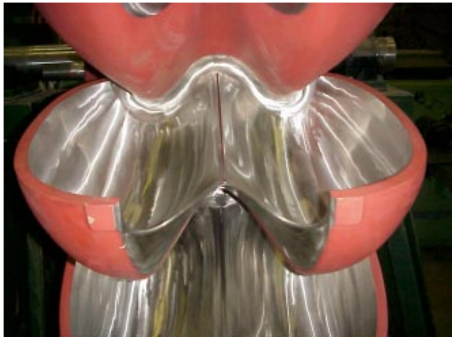
Bild 8 Das fertig polierte Laufrad: Besserer Wirkungsgrad, längere Standzeiten.
