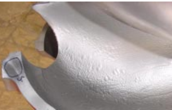
Bild 3 Ein weiterer Schadensmechanismus ist der Tropfenschlag. Dabei schlagen Wassertropfen, weil sie immer wieder auf die selbe Stelle im Laufrad geschleudert werden, Dellen aus dem Laufrad heraus. Die Ursache kann in einem divergierenden Strahl liegen, der an seiner Aussenseite «ausfranst», kann aber auch von einer stumpfen Mittelschneide herrühren, die bewirkt, dass der Strahl nach Aufprall auf der Schneide sich teilweise in Tropfen auflöst.
