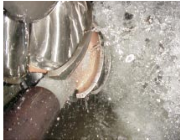
Bild 5 Vollbeaufschlagte korrigierte Schaufel im volldimensionalen Prüfstand.
