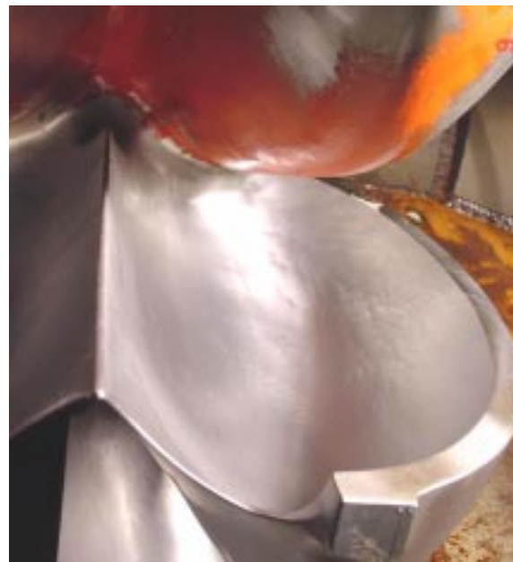
Bild 1 Schadensbeginn: sanfte Wellenbildung, die ihren Ursprung in den Unstetigkeiten des Materials und der Form hat.
