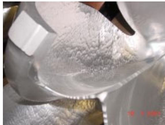
Bild 2 Die Amplitude der Wellen wird im Verlauf der Schadensentwicklung immer akzentuierter bis sich im Endstadium Schuppen bilden, im Bild ähnlich wie eine Luftaufnahme einer Dünenlandschaft mit sanften Rücken und Tälern und scharfen Graten.
