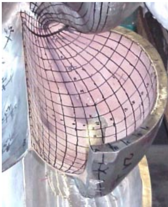
Bild 6 Optimierte Geometrie eines Peltonbeckers bereit zum Abtasten mit dem Roboterarm.
