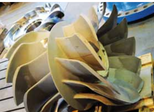
Das stark beschädigte Doppelfrancisrad bei Grimsel Hydro.
