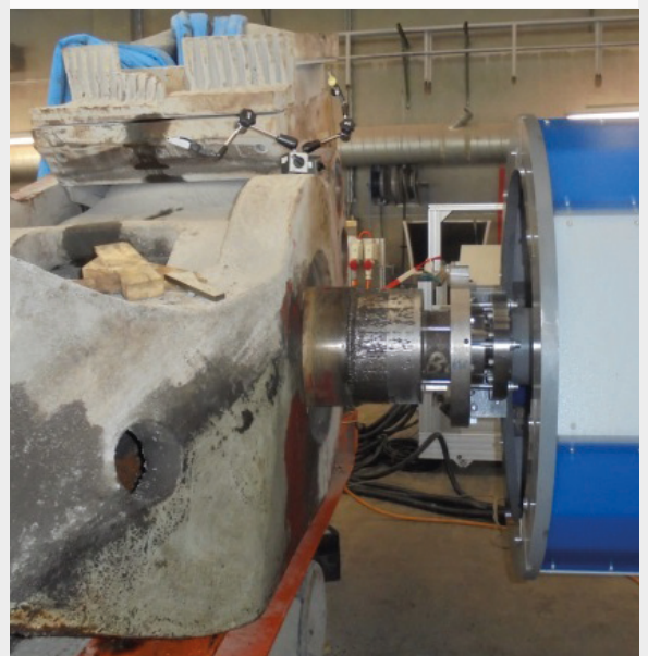
Aufarbeitung eines Lagerzapfens mittels Unterdrehen und Aufschweißen in der Firma Holcim.
