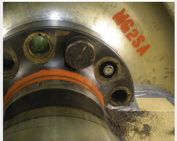
Bearbeitung der Wellenbohrungen im Kraftwerk Kaprun. Anpassung der alten Turbinenwelle auf neues Laufrad mit Spreizbolzen.
