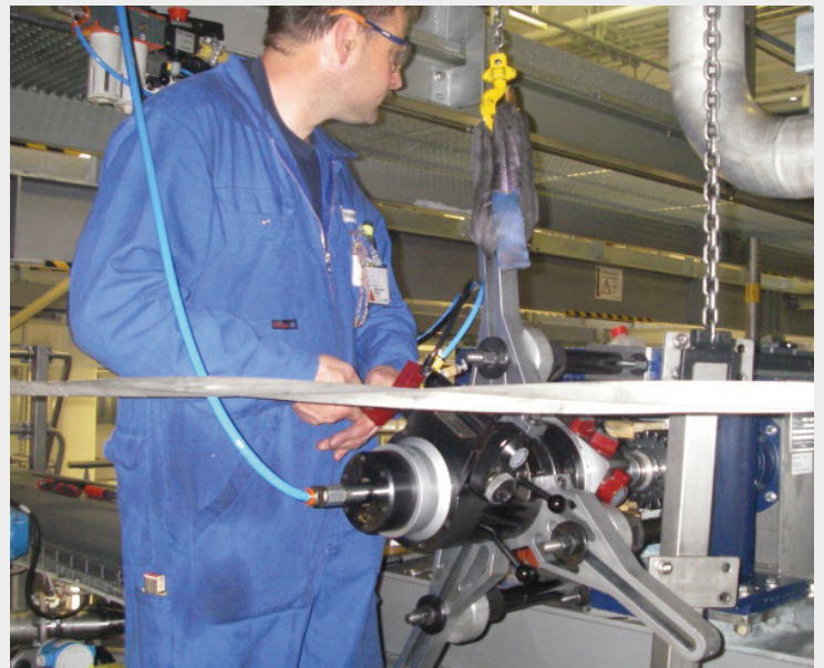
Bearbeitung eines Lagerzapfens eines Mischers bei der Firma SIKA.
