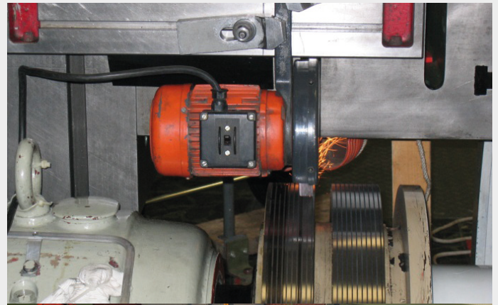
Ausdrehen des Passdurchmessers zur Aufnahme des Einsatzringes im Kraftwerk Grimsel 2.
