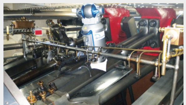
Kurbelwellenvermessung bei einem Dampfschiff
