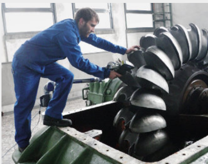
Laufradvermessung im Kraftwerk (links) und Schweissgutkontrolle bei einer Reparatur (rechts)
