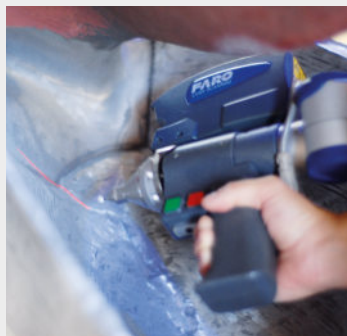
Laufradvermessung im Kraftwerk (links) und Schweissgutkontrolle bei einer Reparatur (rechts)
