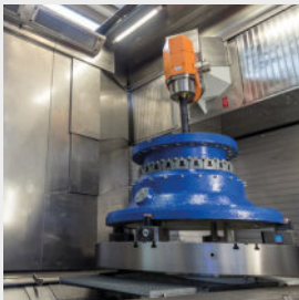
Reiden RX18 Bearbeitungszentrum Drehtisch Ø 1800
