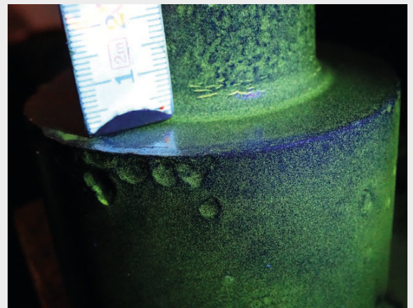
Rissartige Anzeigen bei einer Schraube
