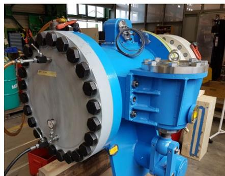
Dichtheitsprüfung und Druckprobe
