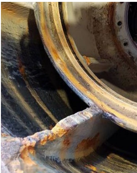
Starke Beschädigung am Gehäuse, den Kolbenführungsrippen und der Antriebsstange
