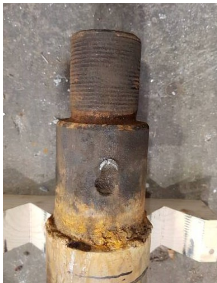
Starke Beschädigung am Gehäuse, den Kolbenführungsrippen und der Antriebsstange
