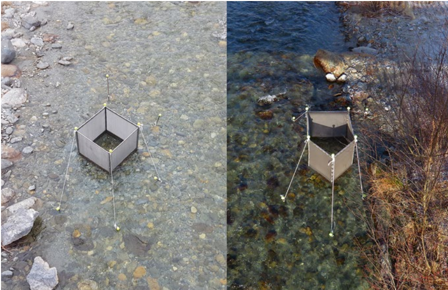
Bild 3: Die installierten Emergenzboxen: links der früheste und rechts der späteste Laichplatz in der Hasliaare
